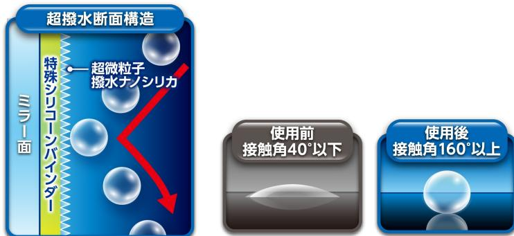
超微粒子“撥水ナノシリカ”を高密度に突起配列させ、接触角160°以上の超撥水皮膜を形成。
